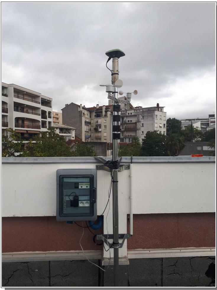
Antenne GNSS et station de météo sur le toit du Lycée Saint-Cricq
